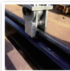
③安全リングが下がっていることを確認し、地切りして一旦停止し、確実にクランプが挟持していることを確認してください。
