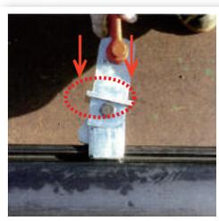
①矢板のセクション部分に本体をセットし、安全リングをセンターボルト位置まで移動します。
