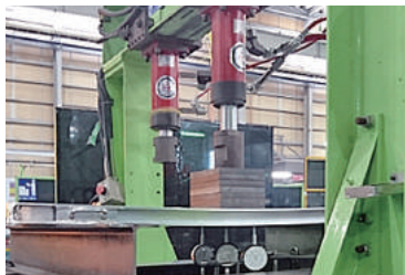
耐荷重2,500kg/枚 クリア (強度確認試験実施) 走行試験は表面写真参照
